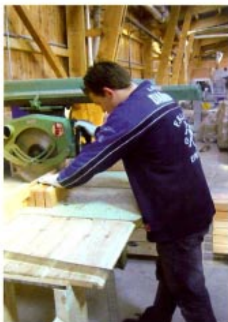
La coupe des parpaings techniques d'angle est encore manuelle mais une nouvelle génération de machines permettra d'automatiser toute la production.
