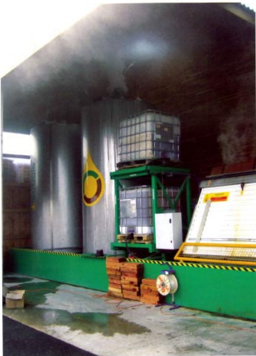
L'unité de production est couplée à une unité de thermo-huilage, la première de ce genre en Limousin.
