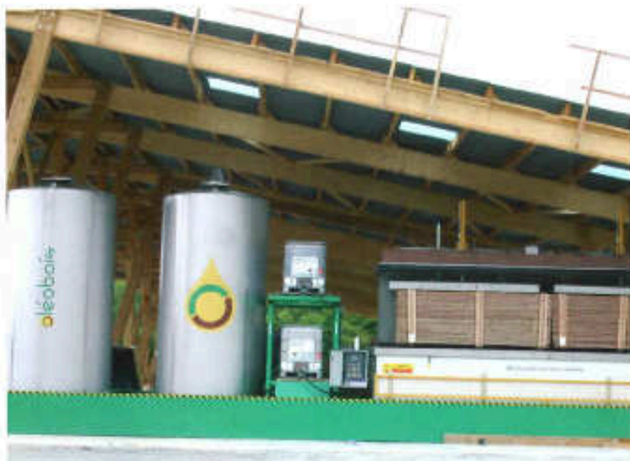
Avec l'oléothermie, les huiles chaudes pénètrent dans les pores du bois à la place de l'eau évaporée et le rendent plus durable.
